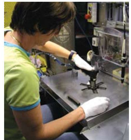
Nova naprava za izdelavo rotorjev za SPE Mehatronika.
