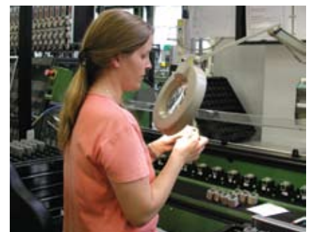
Nova linija za navijanje sekundarnih navitij za vžigalno tuljavo Mercedes-Benz - DUO
