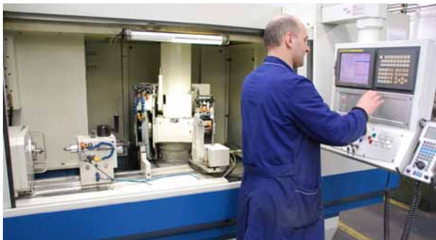
Univerzalni CNC stroj za zunanje in notranje brušenje okroglih obdelovancev. Brus se vrti tudi do 60.000 obratov na minuto.
