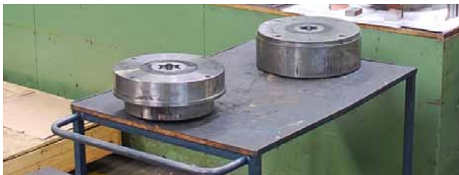
Matrica za hladno preoblikovanje, za kroglasto glavo (homokinetični zglob)
