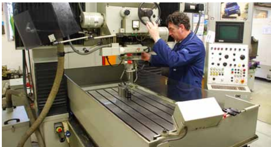
Koordinatni brusni stroj, namenjen preciznemu brušenju zunanjih in notranjih delov. Diamantni, keramični in drugi brusni se lahko vrtijo tudi do 160.000 obratov na minuto.
