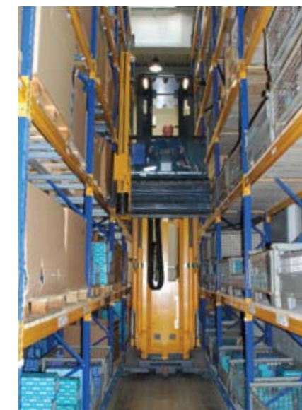
V regalnem skladišču operira visokoregalni viličar tipa ETX.
