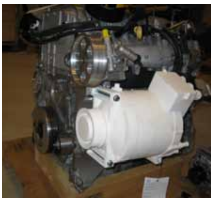
Nadomestilo za alternator - visokonapetostni generator z visokim izkoristkom
